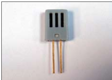
Рис. 7. Емкостный первичный преобразователь относительной влажности 818
