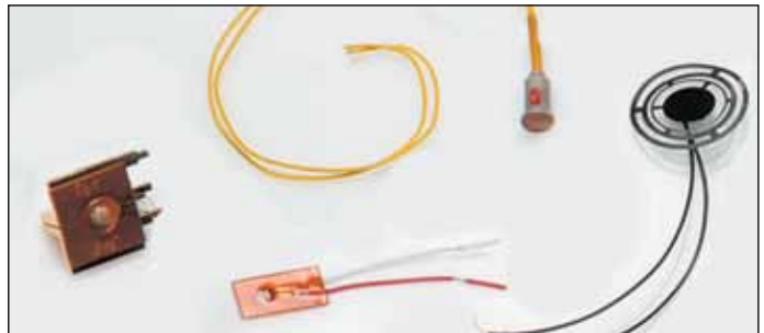
Рис. 9. Металлизированные термосопротивления, установленные на контактные детали
